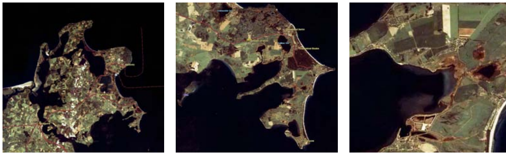
Abbildung 6.4: Rügen's Küstenlänge hängt vom verwendeten Maßstab ab; zwischen den Abbildungen wird der Maßstab jeweils um einen Faktor 4 verringert. Abbildungen aus einem älteren DLR Archiv (KOSMOS Satellit), für neuere Bilder und eigene Spielereien hilft Google-Earth ( http://earth.google.com/ )
