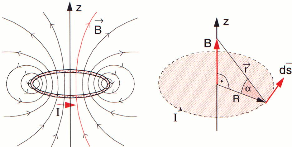
Das Magnetfeld entlang der z-Achse hat aus Symmetriegründen nur eine z-Komponente:
