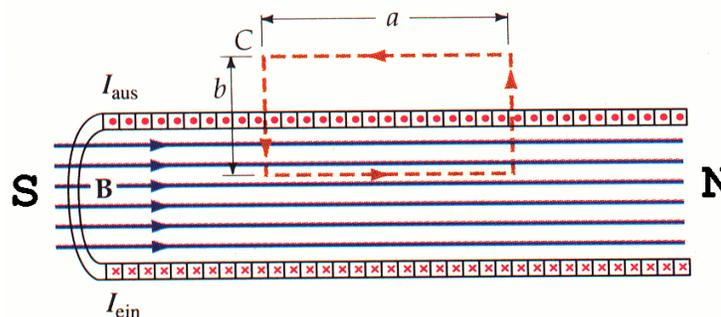
Im Außenraum Feld (nahe) null, im Inneren parallel zur Spulenchse, von S nach N ! Amperesches Gesetz:
