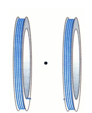
Die Stromrichtung ist in beiden Spulen gleich. Diese Anordnung wird benutzt, um im Zentrum ein recht homogenes horizontales Magnetfeld zu erzeugen.
