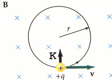
Da die Kraft senkrecht zur Geschwindigkeit steht, wird nur die Richtung geändert, die Teilchenenergie bleibt konstant! Bei geeigneter Einheitenwahl (SI) und unter Hinzunahme auch elektrischer Felder erhalten wir die Lorentzkraft
