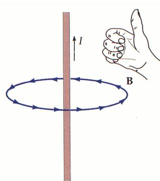
Richtung des Magnetfeldes wechselt mit Stromrichtung, die Stärke nimmt proportional zum Abstand ab. Die Magnetfeldlinien sind geschlossen (Wirbelfeld), die Kraft auf einen gedachten magnetischen Monopol hängt also vom Weg ab: dieses Magnetfeld ist **nicht** konservativ!
