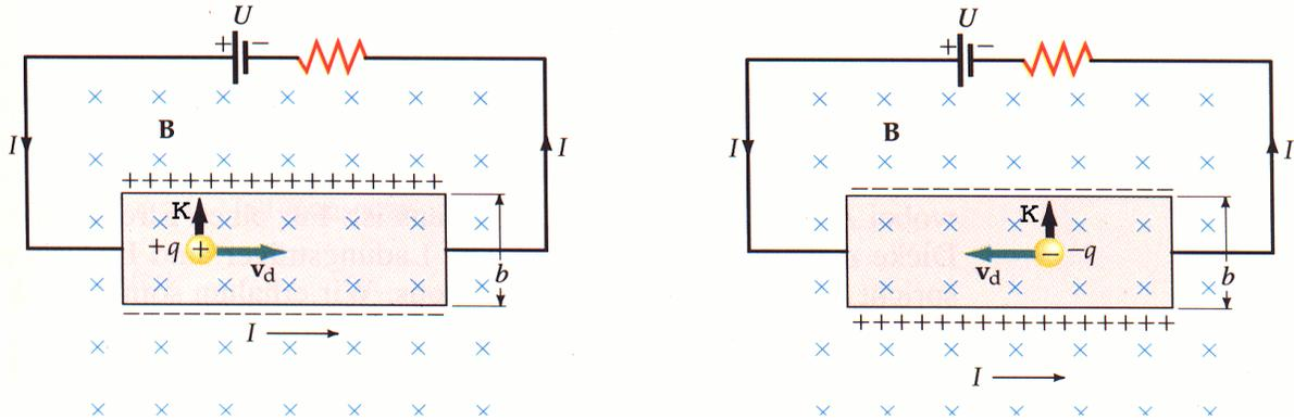
Zum Strom durch die rechteckige Leiterplatte können negative und positive Ladungsträger beitragen. Im folgenden nehmen wir jedoch  $N_+ = 0$  an. Das Magnetfeld lenkt die Ladungsträger ab, so dass eine Ladungsasymmetrie aufgebaut wird, bis das resultierende elektrische Feld die magnetische Lorentzkraft kompensiert: Hall-Effekt. Die geometrischen Abmessungen des Plättchens seien  $l$ ,  $b$ ,  $d$ . Für die 'senkrechten' Kraftkomponenten auf einen negativen Ladungsträger (Elektron) gilt:
