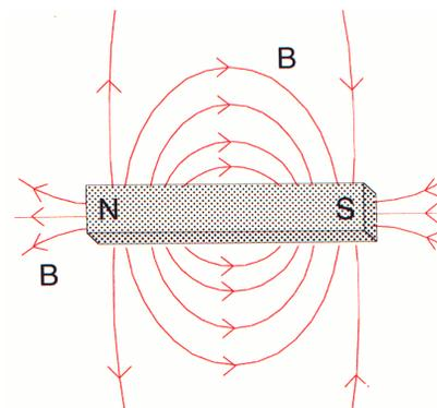
Der Magnetismus solcher Magnete ist permanent vorhanden, man spricht von Permanentmagneten. Zerteilt man einen Magneten, erhält man zwei kleinere Dipole.
